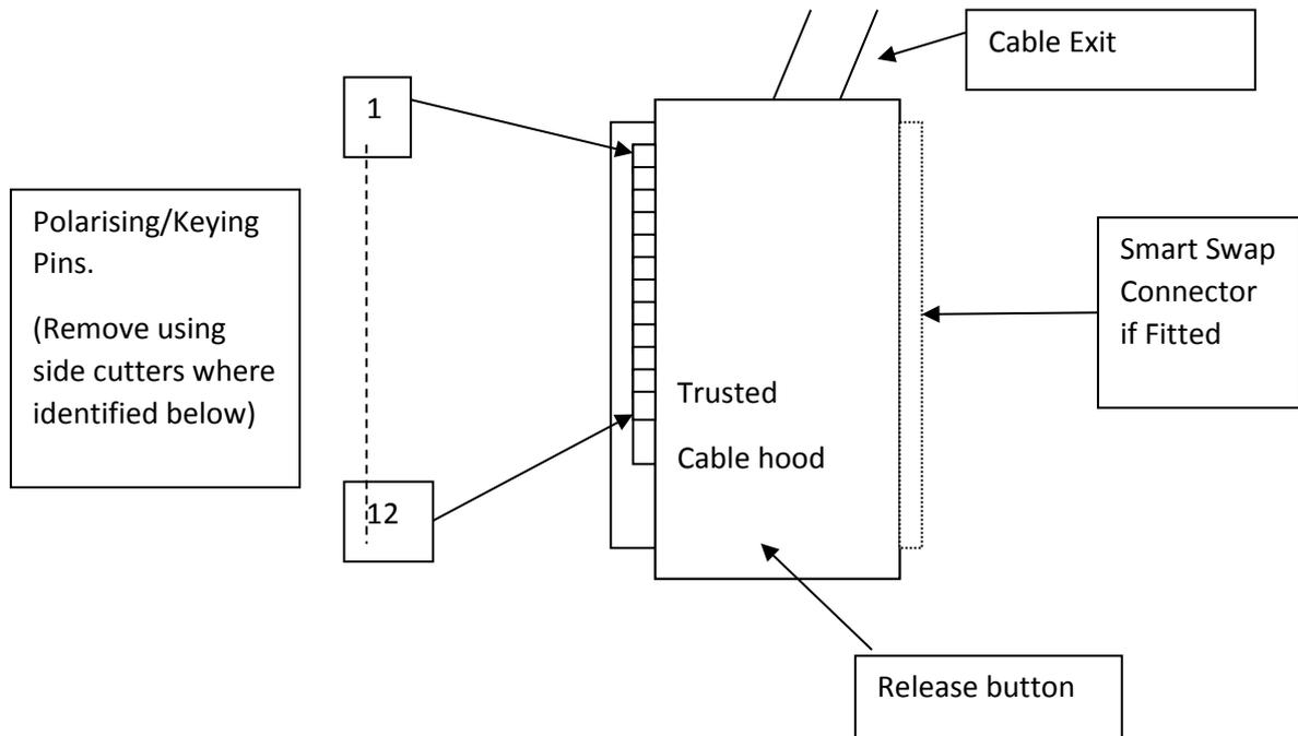
**Figure 4 Module Polarisation**
